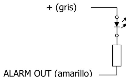
Como conectar una LED con Alarm OUT (cable 3)
